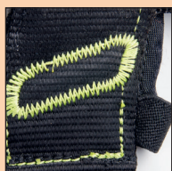
Einzelner Stich fehlt (bei Unsicherheit Hersteller kontaktieren)
