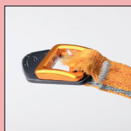
Band in der Schnalle aufgescheuert
