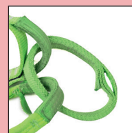
Offene Heftnaht lässt Fehlanwendungen zu
