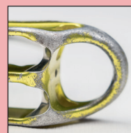
Verschleiß – Scharfe Kanten
