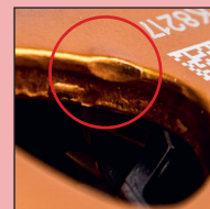
Kerbe im Material durch hohe Sturzbelastung
